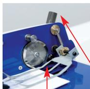
Starke, selbstschärfende Stahlmesser. Schnittbreite variabel einstellbar.
